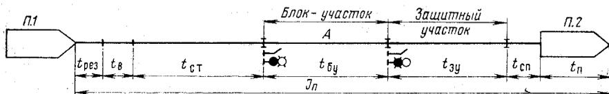
Рис. 7. Интервал между поездами на перегоне
