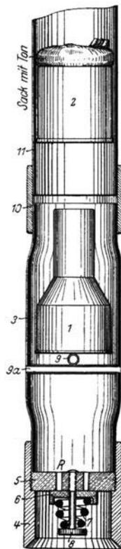
Abb. 23. Rückschlagventilanordnung mit erweitertem Rohrnickel und Brücke bei der Zweistopfenmethode für Muffenrohre.
