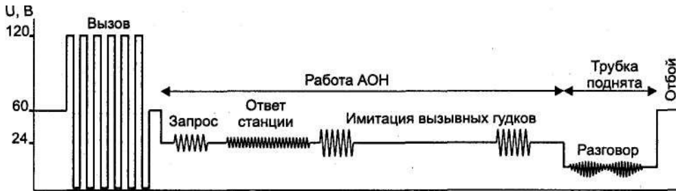
Рис. 10.7. Последовательность сигналов при автоматическом определении номера
