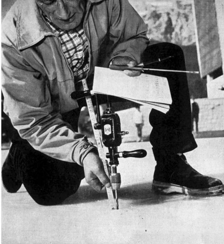
Controllo dello spessore del ghiaccio a Misurina.
