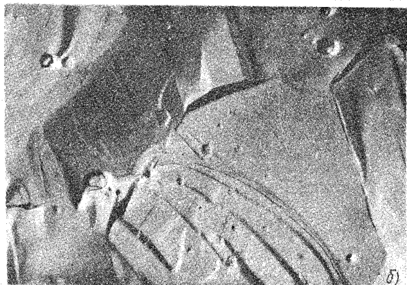
Рис. 1.13. Микроструктура необлученного диоксида урана, спеченного при температуре 1800 °С, полученная методами оптической металлографии (а) и репликовой электронной микроскопии (REM) (б)
