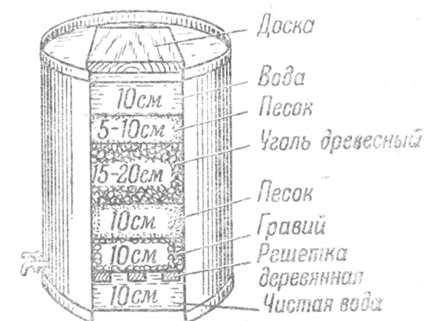
Рис. 28. Полевые фильтры из подручных материалов.
