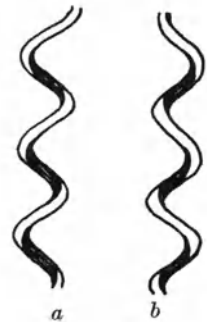
Abb. 2. a rechts-, b links-gewundene Schraubenlinie.
