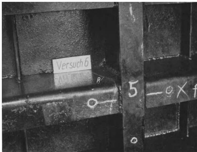
Abb. 12. Längsträger der Stahlzellendecke 6 bei R gerissen.
