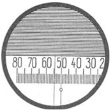
Abb. 86. Gesichtsfeld des Ablesefernrohres am Quarzfadenmagnetometer.
