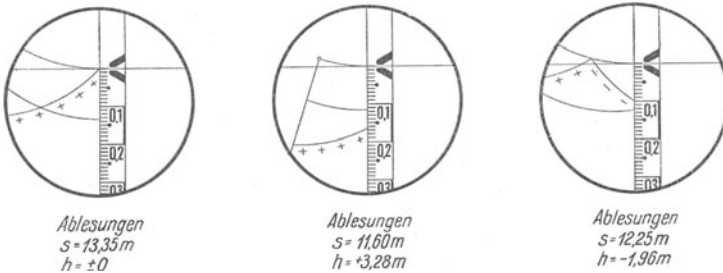
Abb. 132. Sehfelder des Hammer-Fennelschen Tachymeters.
