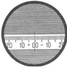
Abb. 84. Gesichtsfeld des Ablesefernrohres am Spiegeldeklinatorium.
