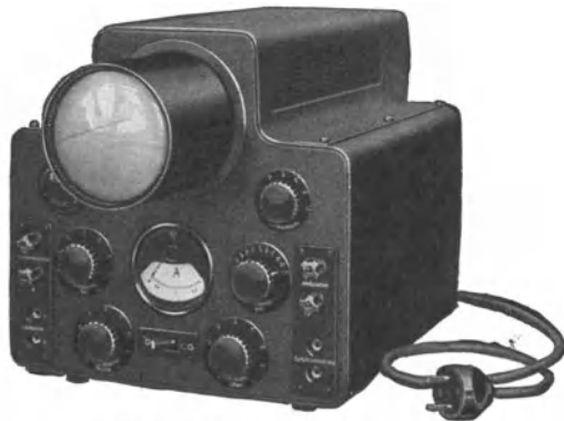
Abb. 18. Kathodenstrahloszillograph als Netzanschlußgerät für Wechselstrom (AEG).
