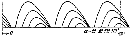
Abb. 240. Verlauf des Gleichstromes eines Sechsphasengleichrichters mit Kathodendrossel mit S/R = 0,25 , \tau = 0 bei verschiedenen Zündverzögerungen.
