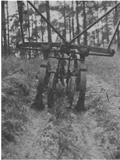
Abb. 206. Maschinenmäßiges Behacken einer Kiefernpflanzung mit dem Neumann-Hilf-schen Igel mit 2 Hackscharen (rechts und links) und 2 Schutzscheiben (in der Mitte). Aufn. des Iffa, Eberswalde.
