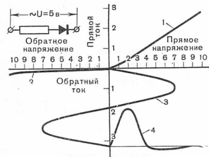
Рис. II-18. Схема процесса выпрямления тока селеновым элементом: 1 — вольтамперная характеристика при протекании тока в прямом направлении; 2 — вольтамперная характеристика при протекании тока в обратном направлении; 3 — синусоида переменного напряжения; 4 — график выпрямленного тока
