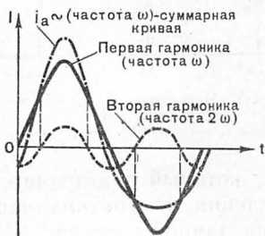
Рис. VII-4. График разложения сложной кривой на составляющие ее гармоники
