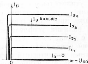
Рис. V-11. Коллекторные характеристики транзисторов типа p-n-p при включении по схеме с общей базой
