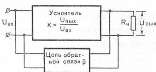
Рис. IX-2. Скелетная схема усилителя с обратной связью (схема параллельной связи) по напряжению
