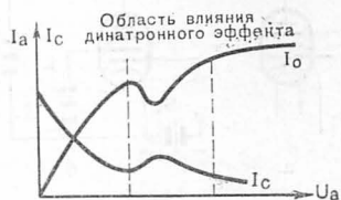
Рис. IV-26. Типовая характеристика анодного тока и тока экранной сетки тетрода
