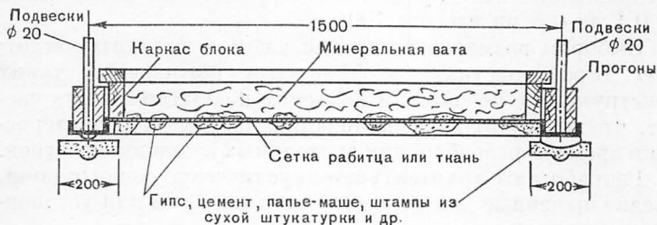
Рис. I-18. Архитектурно-акустический блок (разрез)
