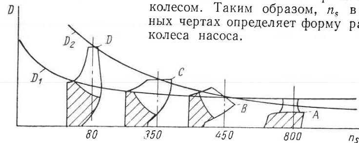
Рис. 3. Формы рабочих колес с различными n_s
