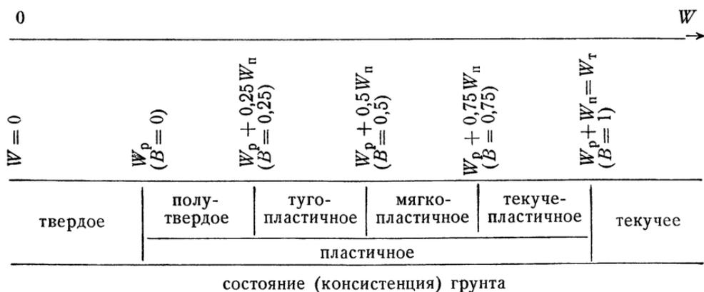
Рис. 1. График состояния глинистых грунтов в зависимости от влажности
