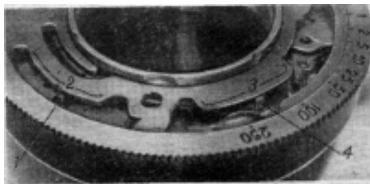
Рис. 57. Установка кольца деления скоростей
