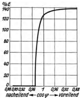
Abb. 98. Selbsterregungsspannung bei kompensierten Asynchronmotoren.
