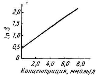
Рис. 36. Кривая зависимости \ln S от концентрации глутаминовой кислоты.
