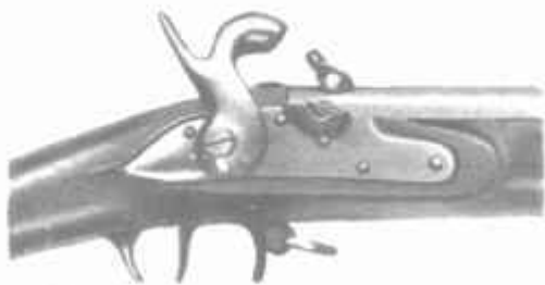
Русское капсюльное ружье. Ударно-капсюльный замок.
