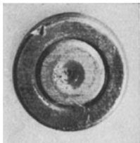
Abb. 15. Auswerferspur am Rande der Patronenhülse (die dreieckige Form ist charakteristisch für eine Walther-Pistole), außerdem Unregelmäßigkeiten am Patronenhülsenboden, die den Abklatsch der Rückwand des Patronenhülsenlagers der Waffe darstellen.
