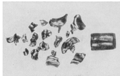
Abb. 2. Splitterung eines Jagdgeschosses bei Durchgang durch eine Wasserzelle von 40 mm Stärke.
