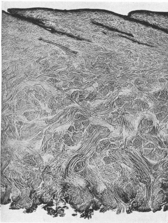
Abb. 2. Vertikalschnitt durch Rindsnarbenspalt mit intakten Narben. Stelle der Entnahme: Schild. (Nach Wilson-Stather-Gierth: Die Chemie der Lederfabrikation.)
