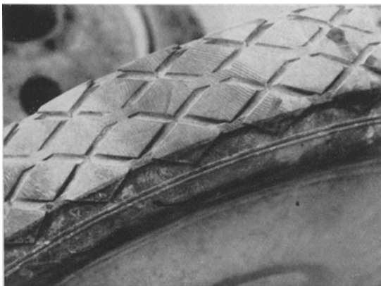
Abb. 7. Stoffabdruck an der Pneumatik des Radreifens.
