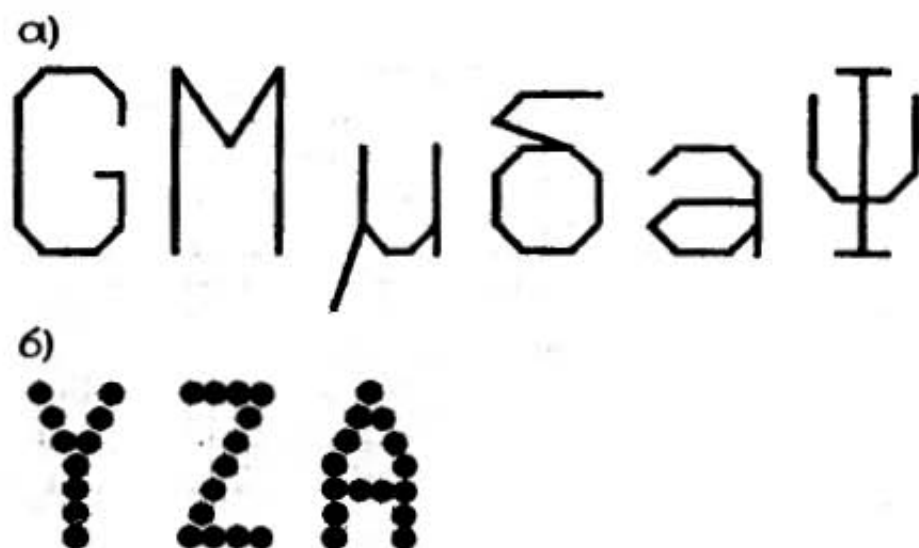
рис. 23. Формирование знаков: а — на графопостроителе; б — на принтере
