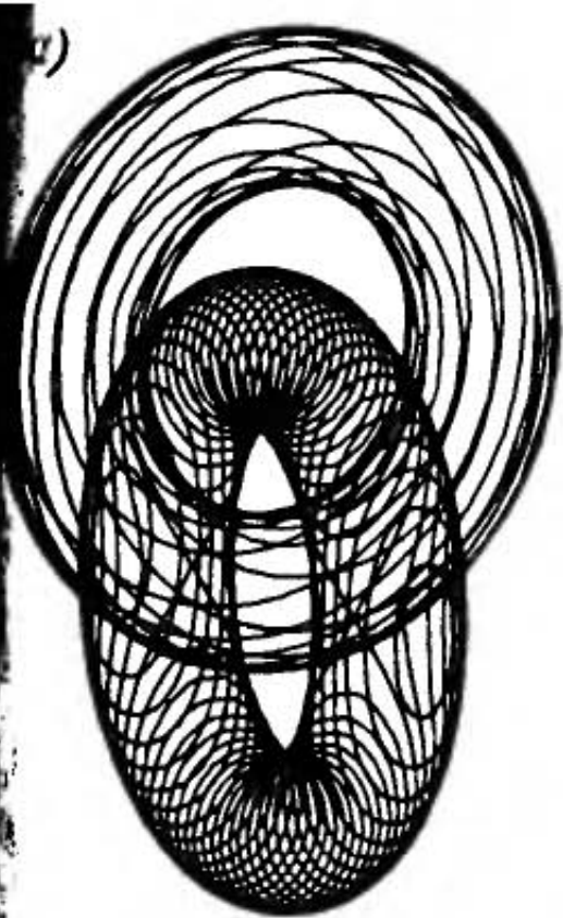
Рис. 31. Изображения: — включающее невидимые линии; б — полученное с помощью алгоритма скрытых линий
