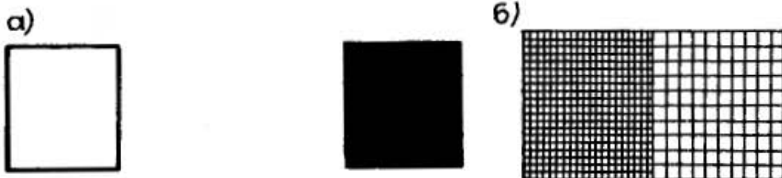
рис. 22. Закраска прямоугольника на принтере (а) и штриховка на графопостроителе (б)
