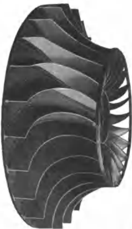
Abb. 253. Flügelrad des Rateauventilators. (Schüchtermann & Krämer, Dortmund.)
