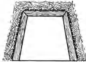
Abb. 151. Deutscher Türstock bei Firsten-Andruck.
