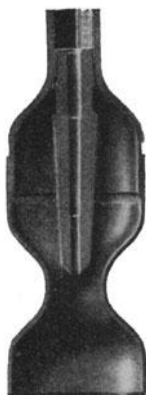
Abb. 41. Fangpulle mit Fangdorn. (Alfred Wirth, Erkelenz.)
