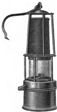
Abb. 246. Sicherheitslampe von Friemann & Wolff, Zwickau.
