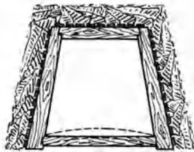
Abb. 158. Türstock mit Sohlenspreize.
