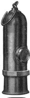
Abb. 247. Untersuchungslampe von Fleißner. (Friedmann & Wolf, Zwickau.)
