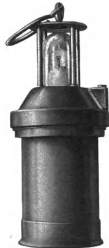
Abb. 275. Elektrische Alkalilampe von Friemann & Wolf.
