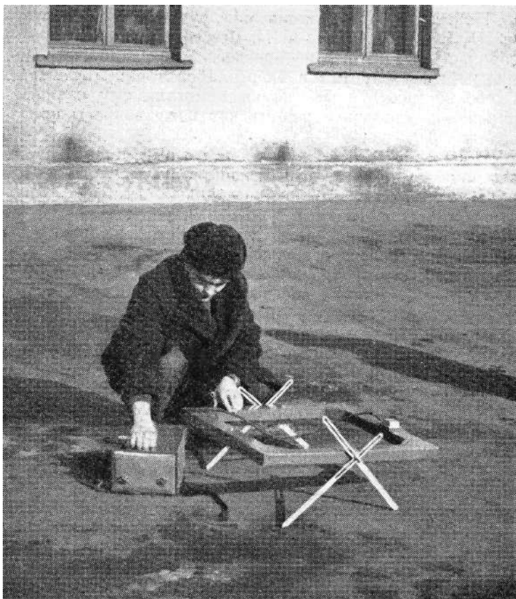
Внедрение нового прибора. С его помощью инженер Б. Г. Белецкий определяет глубину залегания кабеля.
