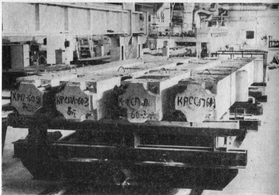
Рис. 5.3. Готовые колонны на вывозной тележке
