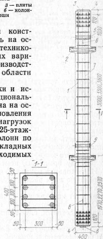
Рис. 3.2. Конструкция колонны
