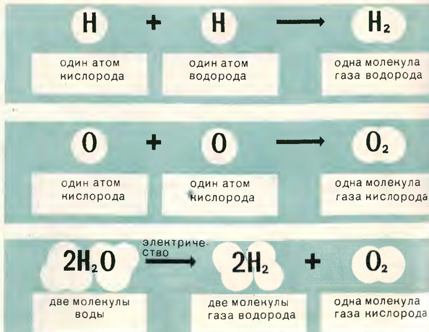
5—3. Суммарная диаграмма, показывающая поведение атомов и молекул при электролизе воды.
