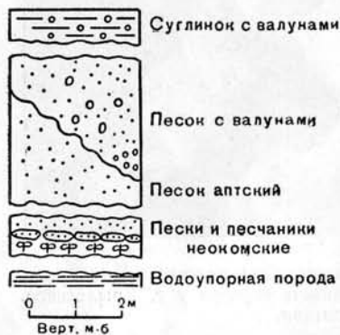
Рис. 11. Сводный геологический разрез правого берега р. Москвы в с. Крылатское (Гуськин овраг).
