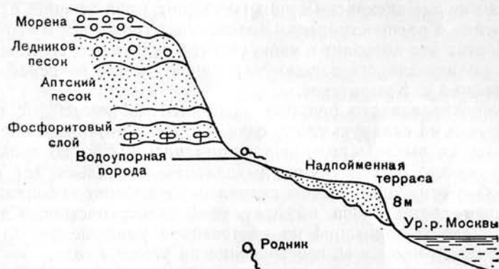
Рис. 12. Схема соотношения пород, слагающих коренной берег р. Москвы в с. Крылатское, и отложенной речной террасы.
