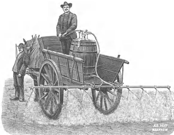
Abb. 423. Hederichspritze „Fortschritt“ (Betriebsdruck ca. 5 Atm.). Hersteller: Rheinpfälzische Maschinen- und Metallwarenfabrik Carl Platz, Ludwigshafen a. Rh. Die Hederichspritze „Fortschritt“ besteht aus einer kräftigen Pumpe für Handbetrieb, die auf ein Holzfaß von ca. 150 Liter Inhalt montiert ist: die Pumpe ist durch eine Schlauchleitung mit einem Verstäuberrohr verbunden, an dem 10 Verstäuber angebracht sind; ein gut wirkendes Rührwerk, das durch den Pumpenhebel betätigt wird, sorgt für eine gründliche Mischung der Flüssigkeit. Das Faß mit der Pumpe wird auf einen beliebigen Wagen gestellt und das Verstäuberrohr in der auf der Abbildung ersichtlichen Weise am Wagen angebracht. Die Pumpe ist äußerst solid und widerstandsfähig gebaut, alle Arbeitsteile sind aus Messing und auswechselbar; der Kolbendurchmesser beträgt 2\frac{1}{2} ". Die Pumpe überragt das Faß nur wenig, ist daher bequem zu bedienen, der Pumpenhebel ist verstellbar, so daß verschiedene Hubhöhe und Kraft angewendet werden kann. Die Arbeitsbreite beträgt 4 m. Ein Manometer zeigt den jeweiligen Druck an.
