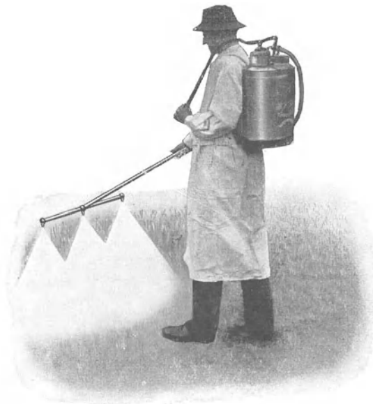
Abb. 429. Tragbare Hederichspritze (Deidesheimertyp) bei der Arbeit. Der Behälter wird ganz mit Flüssigkeit gefüllt. Während des Gebrauchs erhält man den Flüssigkeitsdruck durch Einpumpen der Lösung in den Windkessel. Eig. Aufn.
