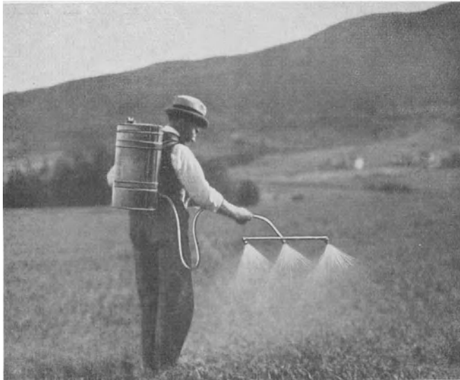
Abb. 429. Tragbare Hederichspritze (Deidesheimertyp) bei der Arbeit. Der Behälter wird ganz mit Flüssigkeit gefüllt. Während des Gebrauchs erhält man den Flüssigkeitsdruck durch Einpumpen der Lösung in den Windkessel. Eig. Aufn.
