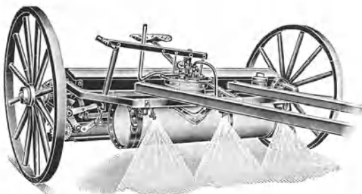
Abb. 437. Düngerstreuer mit angebautem Tauspender. Das in dem Tauspender befindliche Wasser wird durch eine vom Rade aus angetriebene Luftpumpe durch Röhren gepreßt, um dann aus den Düsen heraus in nebelartig feiner Verteilung auf die Pflanzen gesprengt zu werden. Herstellung und Vertrieb durch die Firma Kuxmann & Co., Maschinenfabrik, Bielefeld i. W.
