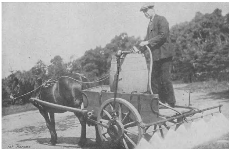
Abb. 424. Die Unkrautspritze System „Forus“ nach Konstruktion von Hønningstad, Stavanger (Norwegen) ist eine fahrbare Unkrautspritze. Sie steht auf einem Karren und wird vom Karrenrade aus angetrieben. Die Einrichtung zur Kraftübertragung ist eingekapselt und wird mit Hilfe von Eisenbügeln und Schrauben an dem einen Rade befestigt. Die Kraftübertragungsachse ist teleskopartig, so daß ihre Länge mit dem Abstand von der Pumpe zum Rade verändert werden kann. An beiden Enden ist sie mit Universalgliedern versehen. Das Pumpen wird durch eine doppelwirkende Diaphragmapumpe bewirkt. Die Pumpeneinrichtung ist mit einer Schraube am Boden einer aufrechtstehenden Tonne befestigt und mit Windkessel, Sicherheitsventil und Druckmesser versehen. Mit Hilfe einer Kupplung wird die Pumpe in und außer Betrieb gesetzt. Das Verteilerrohr ruht auf zwei eisernen Armen. Die Höhe läßt sich verstellen. Der Abstand der Streudüsen beträgt etwa 32 cm. Acht Streuer haben eine Arbeitsbreite von etwa 2,5 m. Bei etwa 90 cm Radhöhe verteilt die Spritze je Hektar etwa 1000 l Flüssigkeit.
