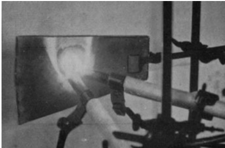
Abb. 110. Ardostanplatte mit eingeschmolzenem Loch.
