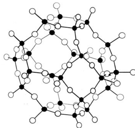
Abb. 29. Räumliche Netzverknüpfung von \text{SiO}_4 -Tetraedern in Sodalith. (Nach F. M. JAEGER.)
