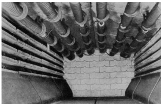
Abb. 203. Inneres eines Kammerofens; Heizwendel an der Seite in Nischen und an der Decke auf keramischen Tragrohren.
