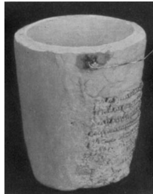
Abb. 225. Tiegelofen mit Platinheizung. (Höhe 75 mm.)
