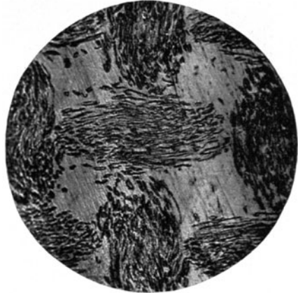
Abb. 75. Oberflächengefüge Typ T, Hellfeld.
