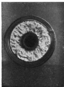
Abb. 231. Querschnitt eines Backerrohres. (2 \times vergrößert.)
