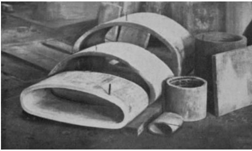
Abb. 223. Ofenmuffeln mit eingebetteten Heizdrähten.
