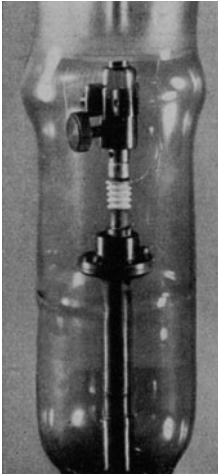
Abb. 177. Calitsockel für einen Vakuumumschalter.
