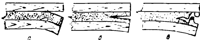
Рис. 18. Характер разрушения клеенного материала: а — адгезионный; б — когезионный; в — смешанный
