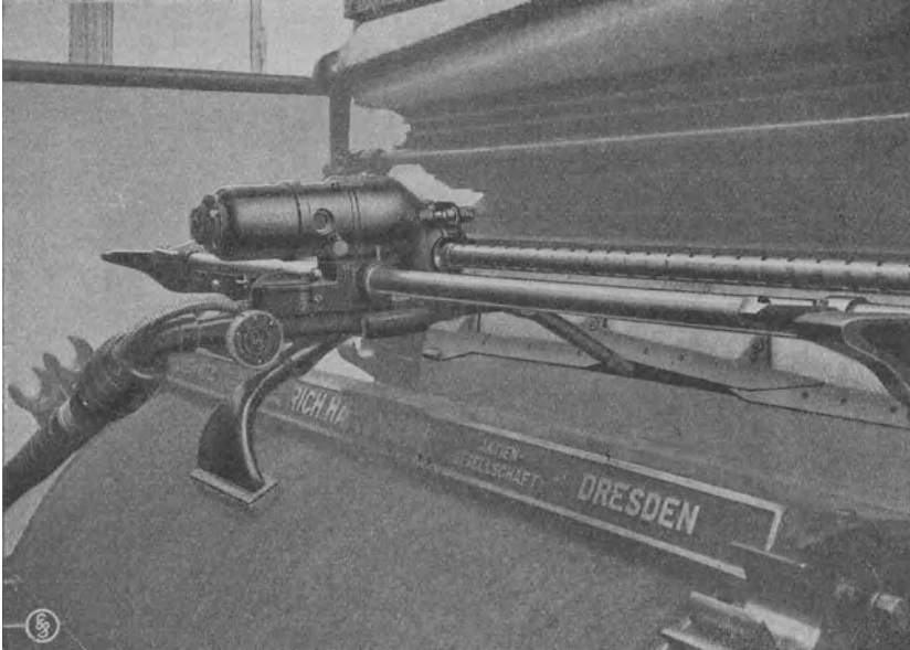
Abb. 121. Ausstoßen des Beschläges mit Saugluft.
