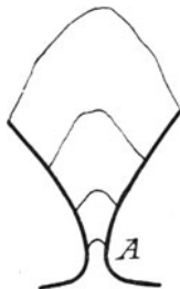
Abb. 98. Auftrieb eines Lichtbogens an Hörnern.
