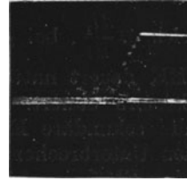
Abb. 360. Öffnungsstrom eines Funkeninduktors ohne Kondensator.
