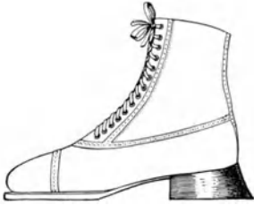
Abb. 271. Orthopädischer Schuh bei Hakenfuß mit hinten vorgebautem Absatz.
