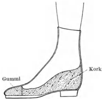
Abb. 331. Spitzfußschuh mit Korkeinlage zum Ausgleich geringer Beinverkürzungen.
