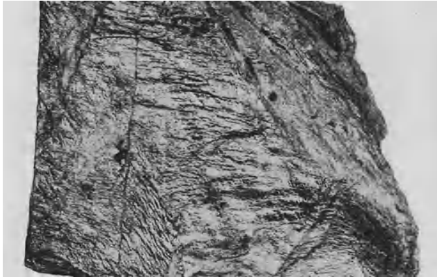
Abb. 90. Quarzphyllit. Innsbruck. Zwei Fältelungen auf s (links-rechts und linksoben-rechtsunten) überlagern sich.
