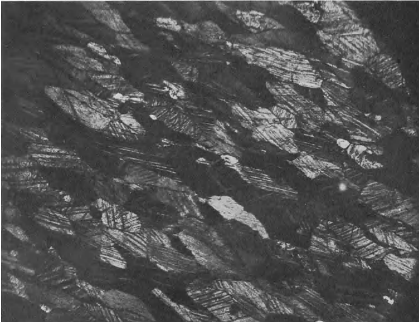
Abb. 82. Marmor. Wattenspitze, Tirol. Schliff nach (bc) . Vergr. nahe 35. Scharf geregeltes Kalzitgefüge zu D 178, 179 mit dementsprechend fast einheitlicher Auslöschung bei Dunkelstellung. s = (ab) ist aus der Kornlänge ersichtlich; e ist in s eingeregelt.
