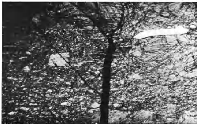
Abb. 97. Marmor. Jaufen, Südtirol. Vergr. nahe 35. Schliff nach (bc) . Mylonitisierung; Risse nach (ac) und (OkI) .
