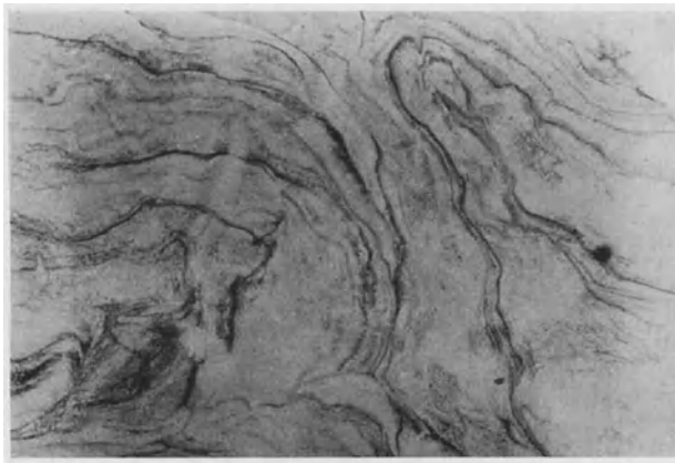
Abb. 125. Faltung ursprünglich punktförmiger Farbschlieren in Plastilin nach regelloser Knetung.
