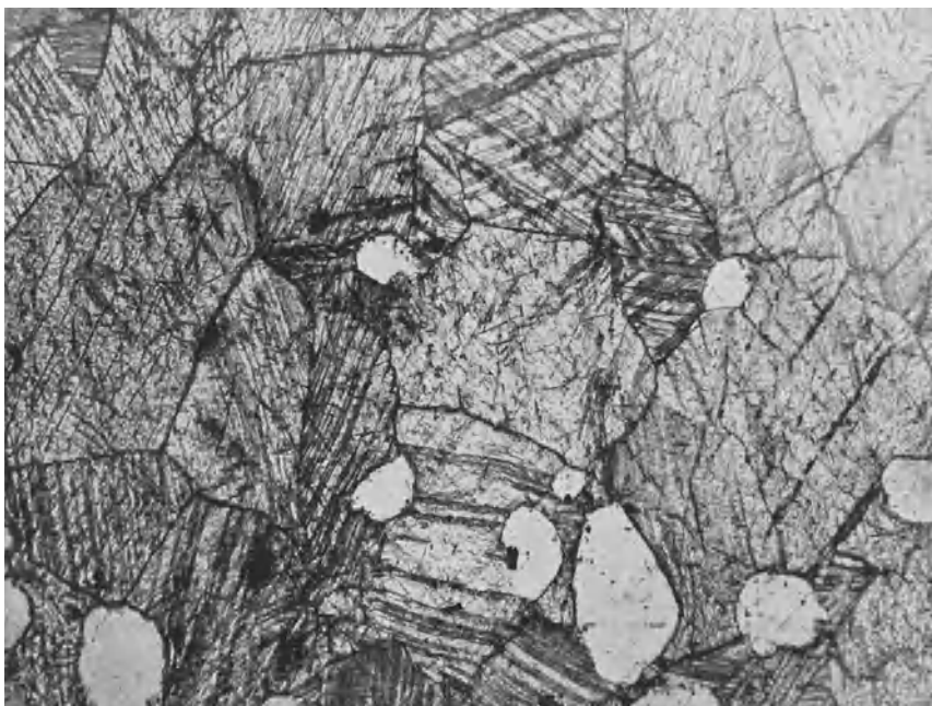
Abb. 80. Kristallisationsgefüge von Kalzit (dunkler) und Quarz (heller) im Kern der Falte D 174—176; Schnitt + B . Vergr. 75. Rundliche bis tropfenförmige Korngestalt des Quarzes typisch für kristallisiertes Quarz in Kalzit-Gefüge; keine Spur mechanischer Beanspruchung; Regelung in D 176. Der gezwungenen Deformation der Kalzite bei Umfassung rings um B im Faltenkern entsprechen gekreuzte Translationen und Zwillingschiebungen mit und ohne korrelierte Stufung der Intergranulare, ferner lebhaft Fadenporen durch Gleitflächenblockierung und durch sowohl affine als nichtaffine (gekrümmte) weitere Zergleitung solcher Vorzeichnungen.
