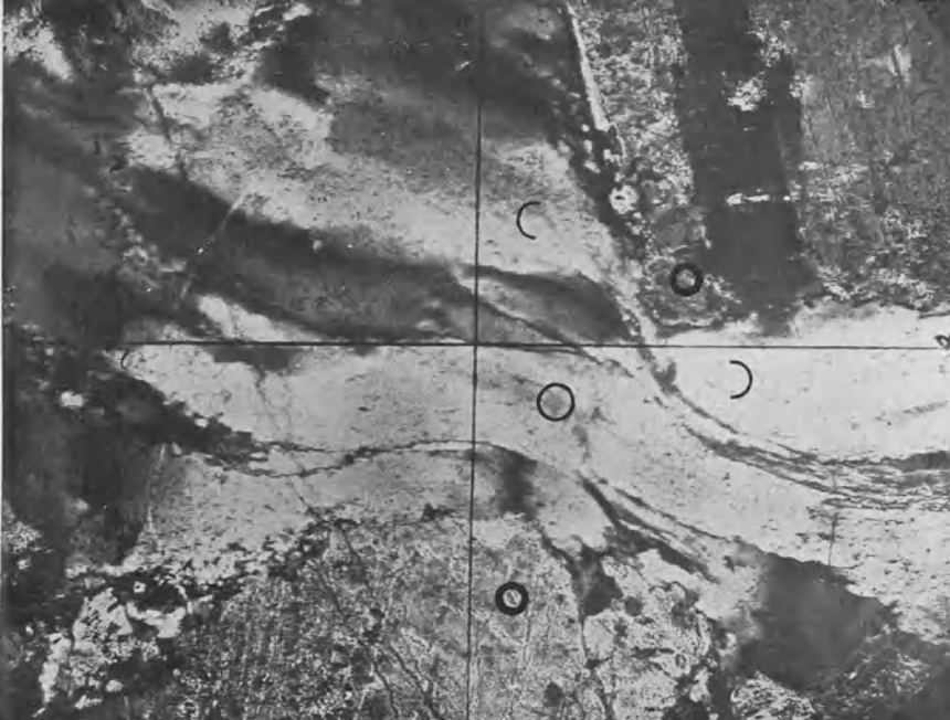
Abb. 66. Gneis-Phyllonit. Mals, Südtirol. Vergr. 75. Durch zwei starre Feldspatkörner (starke Kreise) als Schneiden einer auch durch Rupturen in Feldspat und Quarz erkennbaren ( Okl )-Schere wird Quarzgefüge (dünne Kreise) zerschert. Das Quarzgefüge antwortet dieser Beanspruchung teils durch Trennung eines Kornes (korrespondierende Halbkreise) in zwei Hälften, teils (voller Kreis und andere Körner) durch plastische Biegleitung in den Quarzlamellen subnormal zur c -Achse des Quarzes.
