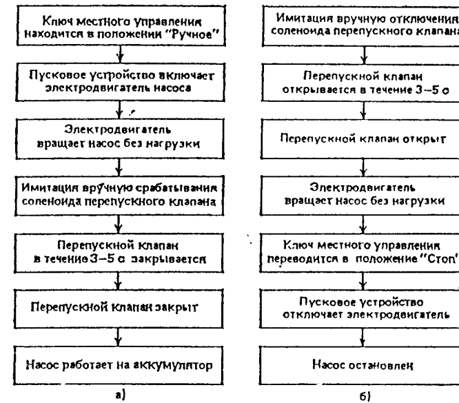
Рис. 10.13. Последовательность операций при управлении от местного ключа: а — пуск насоса; б — остановка насоса
