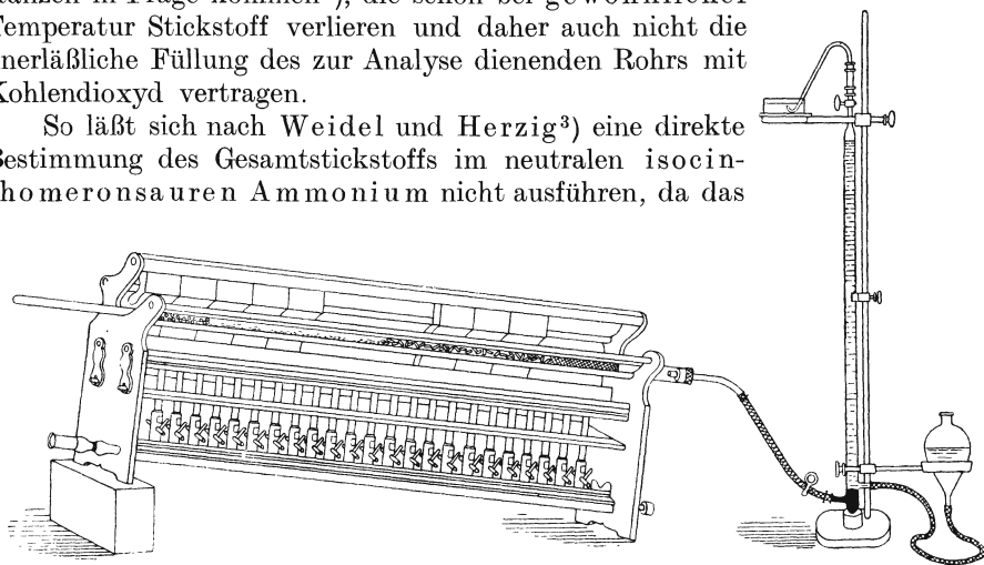
Fig. 170. Stickstoffbestimmung nach Dumas.
