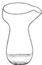
Fig. 206. Der abgesprengte, mit Schnabel versehene untere Teil der Mikrobombe.
