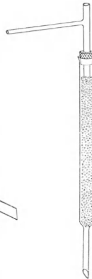
Fig. 29. Fraktionieraufsatz von Hempel.
