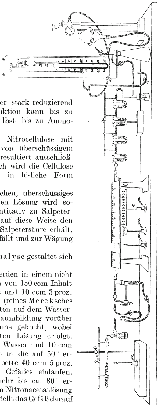
Fig. 192. Stickstoffbestimmung nach Dennstedt.
