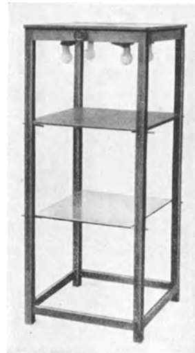
Abb. 1. Photographisches Reproduktionsgestell nach WAGENER.
