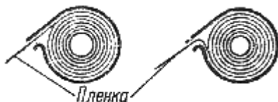
Рис. 37. Правильное (слева) и неправильное (справа) положение пленки в кассете
