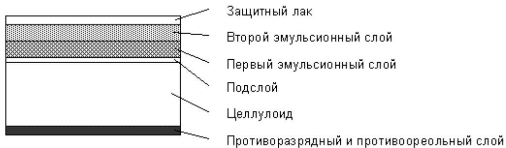
Рис 29. Схематический разрез негативной пленки
