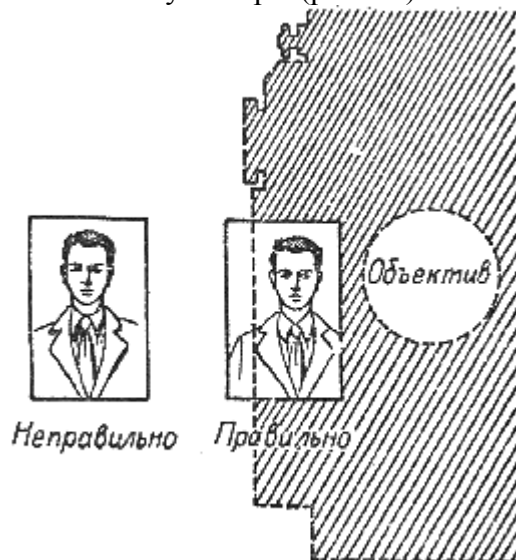
Рис. 42. Поправка на параллакс при съемке с коротких расстояний
