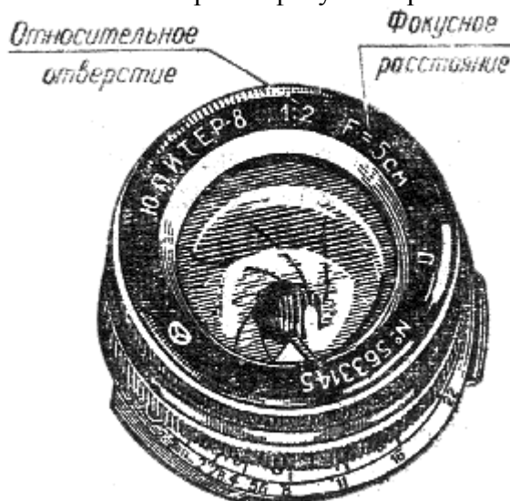
Рис. 6. Величины относительного отверстия и фокусного расстояния наносятся на оправу передней линзы объектива
