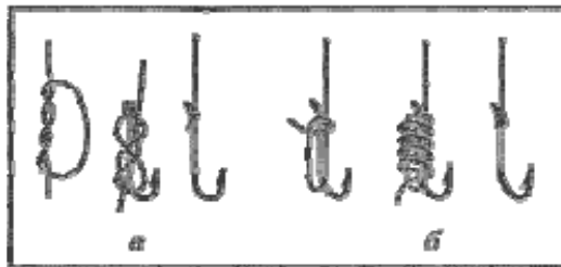
Рис. 4. Способы привязывания крючков к леске: а – «восьмеркой», б – обмоткой
