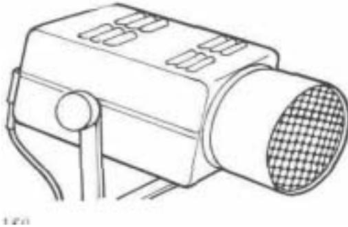
Использование осветителя с сотовой насадкой фон освещен нормально, но чтобы оживить снимок, пучок света направлен сзади, образуя световое пятно. Показано правильное положение экспонометра при этой схеме освещения, позволяющее при измерении захватить и край светового пятна.
