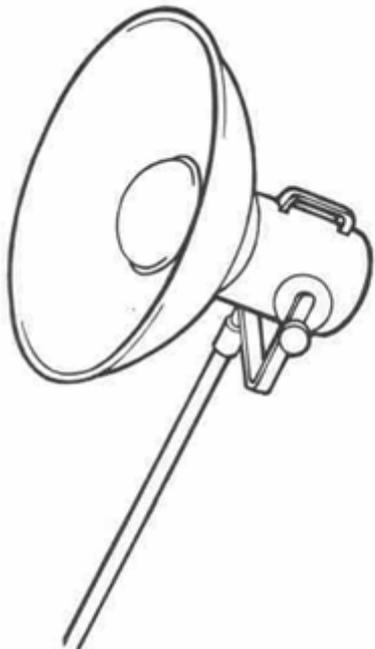
Светоотдача этих моделей в два раза меньше, чем у рефлекторов общего назначения, но так как данный источник света имеет в два раза больший диаметр и не испускает направленных лучей непосредственно от лампы или разрядной трубки электронной вспышки, тени получаются значительно более мягкими.
