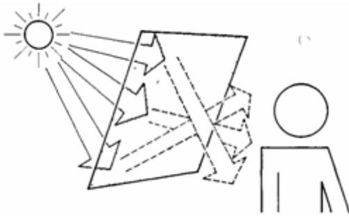
Диффузный экран пропускает свет но меняет его направленный характер позволяя избежать резких теней
