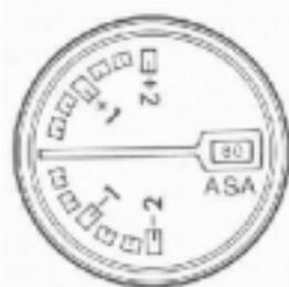
По этой корректирующей шкале, которой оснащены автоматические съемочные камеры, можно на плюс-минус два деления скорректировать экспозицию, автоматически установленную встроенным экспонетром.
