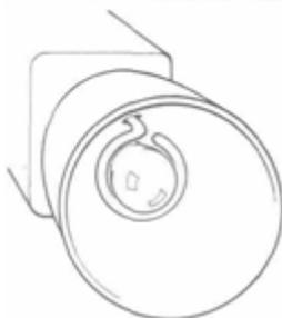
Высокоэффективный глубокий параболический рефлектор формирует узконаправленный пучок света
