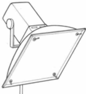
Световой бокс или туманный осветитель снабжены спереди рассеивающим экраном и дают очень мягкое освещение. Степень рассеивания зависит главным образом от размеров этого экрана
