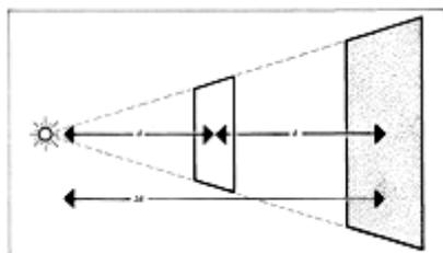
Очень немногие источники света по качеству испускаемого ими излучения приближаются к точечным, но если речь идет об экспозиции и уровнях освещенности, то таковыми можно считать перекальные фотолампы, кинопроекторные лампы, электронные импульсные лампы и другие источники с площадью излучающей или отражающей поверхностей
