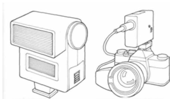
Распространенные электронные вспышки не одинаковы. В качестве примера слева показана вспышка с двумя светящимися головками. Верхняя может поворачиваться, обеспечивая отраженное излучение, а нижняя в то же время обеспечивает переднюю подсветку. Справа показана кольцевая электронная вспышка, которая дает совершенно бестеневое освещение для съемки в крупном масштабе
