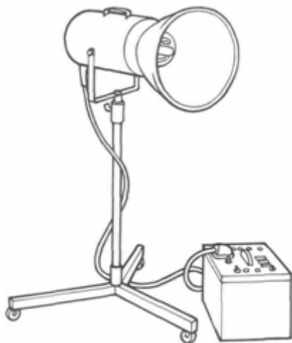
Студийная электронная вспышка с отдельным напольным источником питания и осветительной головкой минимального веса является идеальной осветительной установкой для больших студий. Осветительная головка содержит конденсаторы большой емкости, но малого веса, позволяющие избежать потерь мощности, обусловленных применением кабеля между конденсаторами и разрядной трубкой.
