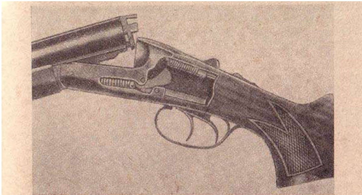
РИС. 66. Ружье фирмы «Винчестер» (США) с горизонтальным расположением стволов модели 21, с модифицированным замковым механизмом системы «Энсон-Дилей»
