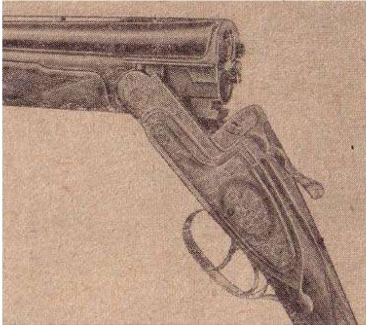
РИС. 12. Вид на ружье МЦ-9 со стороны ствольной коробки с открытыми, вертикально расположенными стволами 12-го калибра. Ружье спортивное с эжекторным механизмом. Служит для стрельбы на траншейной площадке. Замки боковые отъемные
