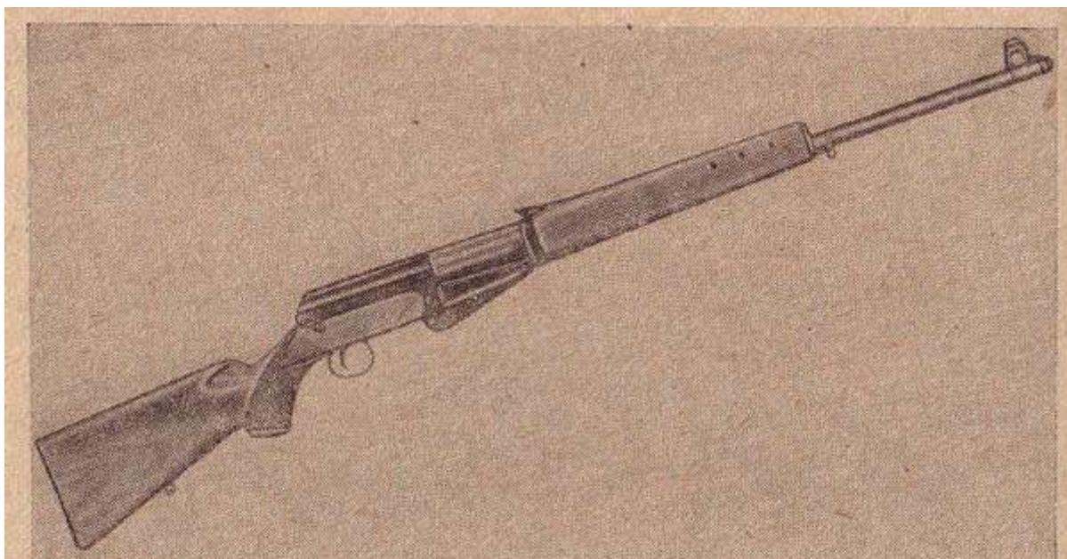
РИС. 38. Общий вид карабина моделей «Медведь-1» и «Медведь-2» Ижевского завода. Карабин самозарядный, действует на отводе пороховых газов из канала ствола. Калибр 9,3 мм. Модель «Медведь-1» имеет неотъемный магазин на три патрона (этот карабин показан на рисунке); а модель «Медведь-2» имеет отъемный коробчатый магазин на пять патронов. Это очень мощное в огневом отношении ружье с простым и надежным механизмом. Кроме секторного прицела, карабин комплектуют 4 × или 6 × оптическим прицелом
