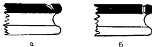
Рис. 1 Правильный (а) и неправильный (б) вырезы в диске
