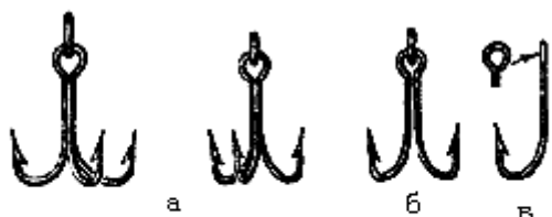
Рис. 10 Крючки: а-тройник, б-двойник, в-одинарный
