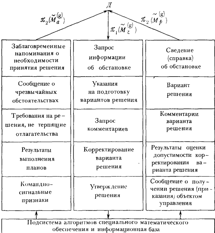
Рис. 5.3. Цикл выработки варианта решения в диалоге и состав основных информационных массивов: \tilde{M}_a^{(g)} — подмножество массивов, выдаваемых автоматически; \tilde{M}_z^{(g)} — подмножество массивов, содержащих запросы (указания на работу средствам автоматизации); \tilde{M}_p^{(g)} — подмножество массивов, содержащих ответы на запросы.
