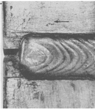
Abb. 243. Liegend geschweißte Stumpnaht an 5 mm-Bleiblech.
