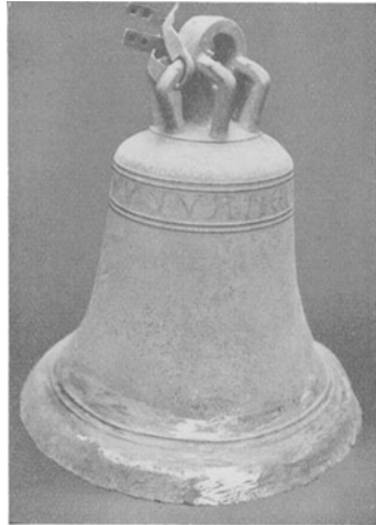
Abb. 242. Fertig geschweißte bronzene Kirchenglocke.
