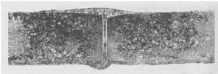
Abb. 267. Schliff eines mit Messingschweißdraht gelöteten 10 mm-Kupferblechs (natürliche Größe).
