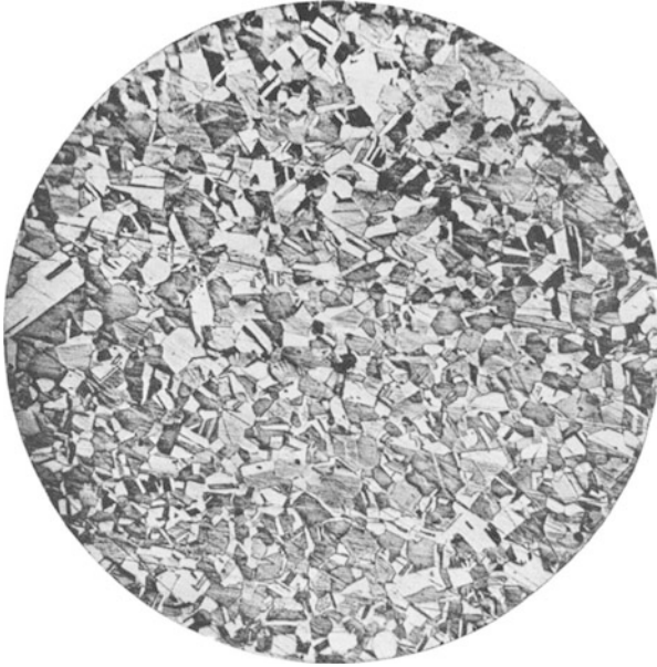
Abb. 331. Kleingefüge von Kupfer, ungeschweißt ( V = 115 ).
