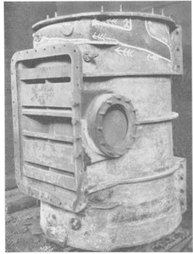
Abb. 222. Dampfzylinder (Abb. 221), fertig geschweißt.
