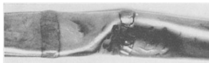
Abb. 230. Verformungsprobe eines geschweißten Kupferrohres.
