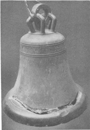
Abb. 241. Bronzene Kirchenglocke, zur Schweißung vorbereitet.
