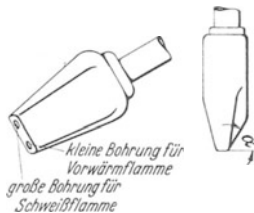
Abb. 89. Normaler Zweiflammnbrenner (für Kantenvorwärmung).
