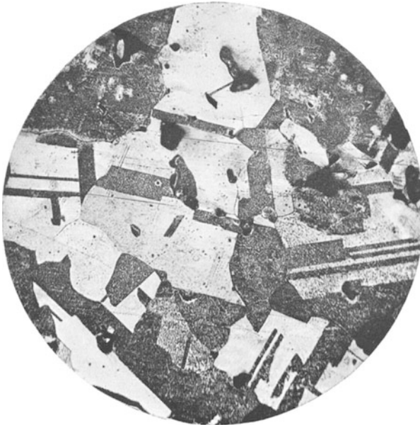
Abb. 332. Grobkristallines Kleingefüge einer unvergüteten Kupferschweißnaht ( V = 115 ).
