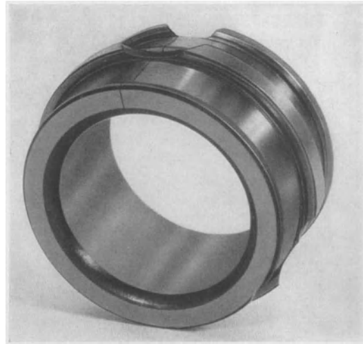
(1149) Riß und Bruchstellen durch harten Schlag.
