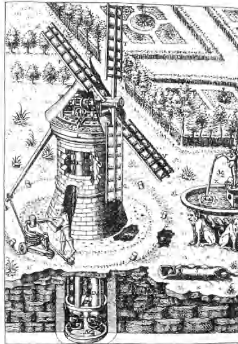
(11) Lagerung eines Pumpwerkes mit Windrad von RAMELLI 1588.
