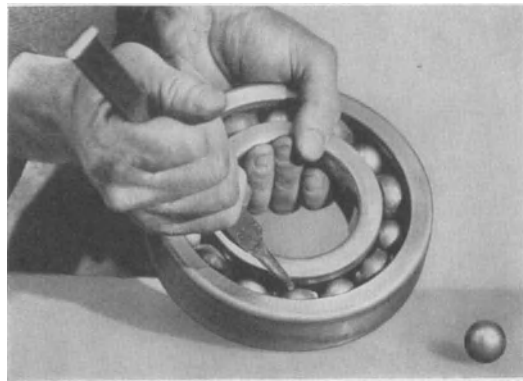
(1069 a–b) Zerlegen eines einreihigen Rillenkugellagers mit Einfüllöffnung.
