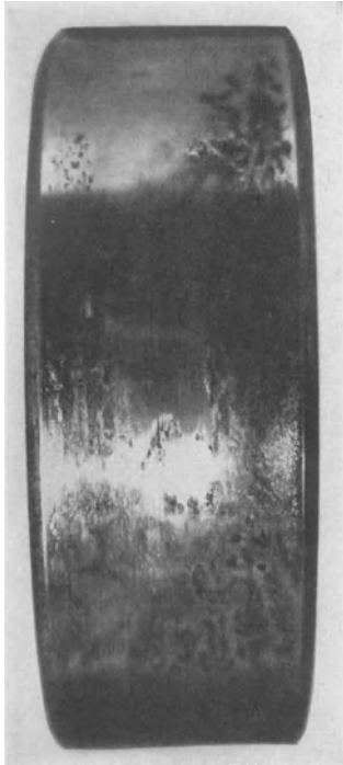
(1154) Reibrost auf dem Mantel eines Außenringes.
