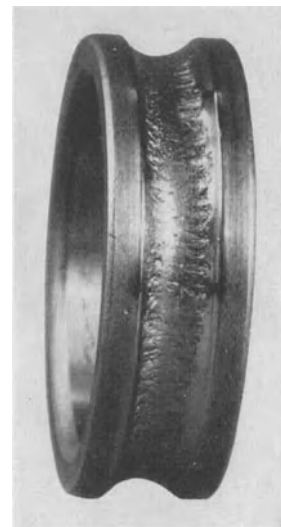
(1078) Ringsherum laufende Schälung bei dem Innenring eines Radialagers.
