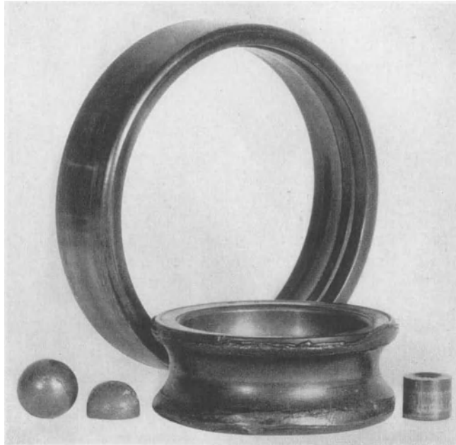
(1116) Enthärtung, Verformung und Verschleiß eines Zylinderrollenlagers, Rollen zu Kugeln verformt.
