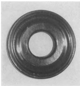
(1160) Freßspuren am Rande der Laufspur einer Längslagerscheibe.
