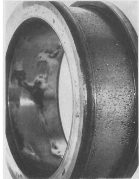
(1159) Stark poröse Laufspur eines Innenringes.
