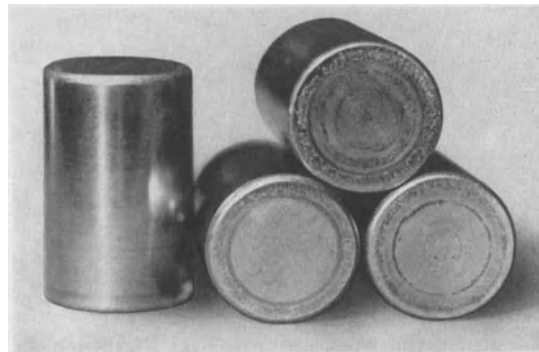
(1165) Freßspuren an den Seitenflächen von Rollen (natürliche Größe).
