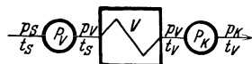
Abb. 2. Schaltung eines Vorwärmers (oder Economisers) V , der nicht auf vollen Kesseldruck beansprucht werden darf, zwischen Vorwärmepumpe P_v und Speisepumpe P_k . Der Druck p_v nach der Vorwärmepumpe muß größer sein als der zur Temperatur t_v gehörige Sättigungsdruck.
