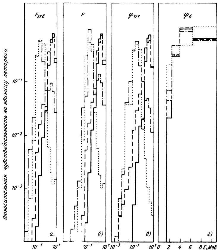
Рис. 3.23. Энергетическая зависимость относительной чувствительности мощности эквивалентной дозы P_{\text{ЭКВ}} (а), мощности поглощенной дозы в ткани P (б), плотности потока быстрых нейтронов \varphi_{\delta} (г) и показаний детектора 1/\nu - \varphi_{1/\nu} (в) за гетерогенной защитой Na (4,6 м) + Fe (0,9 м) к параметрам n_i функции распределения нейтронов бесконечных плоских мононаправленных источников с исходными спектрами f (—), f + 1/E (---), КПН (...) и FTR (- · - · -)
