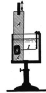
Abb. 79. Innere Reibung (Viskosität) einer Flüssigkeit (aus POHL, Einführung in die Physik, Bd. 1).
