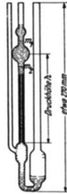
Abb. 79a. Viskosimeter nach UBBELOHDE (aus UBBELOHDE, L.: Zur Viskosimetrie.)
