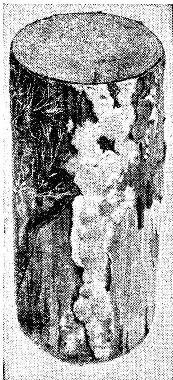
Рис. 3. Древесина сосны с гнилью в ранней стадии поражения столбовым грибом
