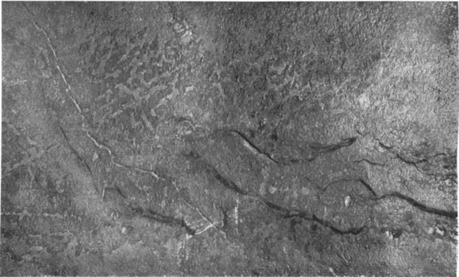
Abb. 18. Oberfläche eines Bleches mit parallelen Schrumpfrissen.
