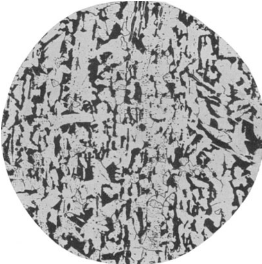
Abb. 26. Reste von Gußstruktur aus der Mitte eines starken Blechquerschnittes. × 50
