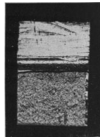
Abb. 35. Kerbschlagprobe mit einseitiger Kornvergrößerung an der Oberfläche (Rückkristallisation).
