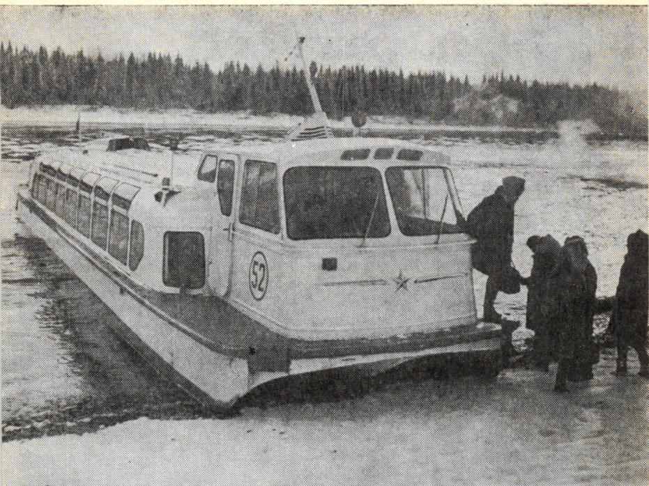
Глиссирующий теплоход «Заря». Пассажиры высаживаются на берег без трапа.
