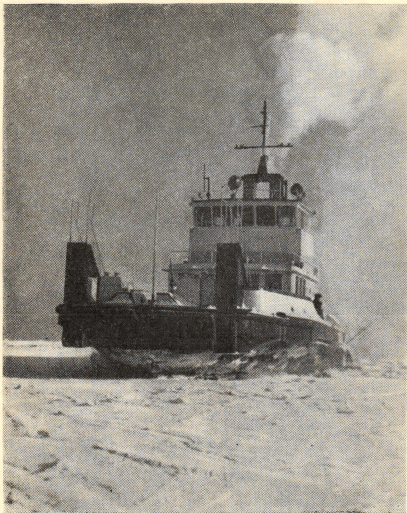
Рейдовый буксирный теплоход ледокольного типа, серийное производство которых начато на Чистопольском заводе.
