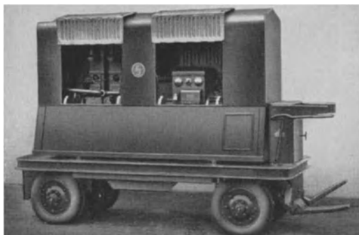
Abb. 65. Dieselschweißgenerator mit eigenem Fahrtrieb.
