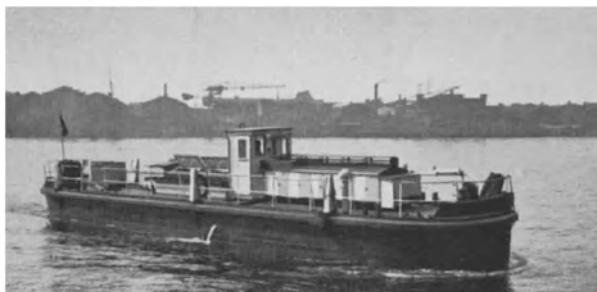
Abb. 67. Schiff mit dieselgetriebener Mehrstellenschweißanlage.
