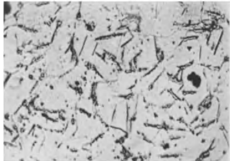
Abb. 109. Nitridnadeln im Schweißgut (normal-geglüht). V = 530 \times , davon \frac{3}{4} .
