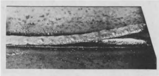
Abb. 93. Selbsttätiges Abheben der Schlacke.
